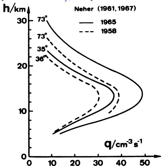
Рис. 2. Зависимость скорости ионизации (по горизонтали в  $\text{cm}^{-3} \cdot \text{с}^{-1}$ ) от высоты (по вертикали в км) для различных геомагнитных широт в годы максимума (1958) и минимума (1965) 11-летнего цикла солнечной активности. Рисунок из работы [Gringel et al. \[1986\]](#) по данным измерений из работ [Neher \[1961, 1967\]](#).
