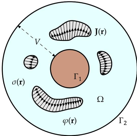
**Рис. 5.** Геометрия задачи о ГЭЦ постоянного тока. Стрелками схематически показано распределение плотности тока источников  $\mathbf{J}$ , отличной от нуля только внутри облаков с развинутой электрической структурой.
