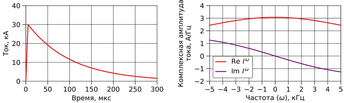
**Рис. 17.** Слева: модельная зависимость (82) тока возвратного удара в молниевом разряде облако — земля от времени  $(t - t_j)$ . Параметры:  $I_0^{(j)} = 30$  кА,  $\tau_1 = 5$  мкс,  $\tau_2 = 100$  мкс. Справа: модельная зависимость (83) комплексной амплитуды тока возвратного удара в молниевом разряде облако — земля от частоты  $\omega$ . Параметры те же, графики построены для  $t_j = 0$ . Отдельно показаны действительная часть (красная кривая) и мнимая часть (фиолетовая кривая).
