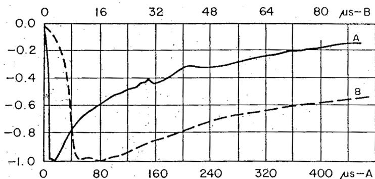
**Рис. 16.** Характерный вид осциллограммы тока возвратного удара в нисходящем отрицательном разряде облако — земля. По горизонтали отложено время в мкс (две шкалы соответствуют двум графикам и двум масштабам), по вертикали — нисходящий (и потому отрицательный) ток в условных единицах. Рисунок из работы [Berger et al. \[1975\]](#).
