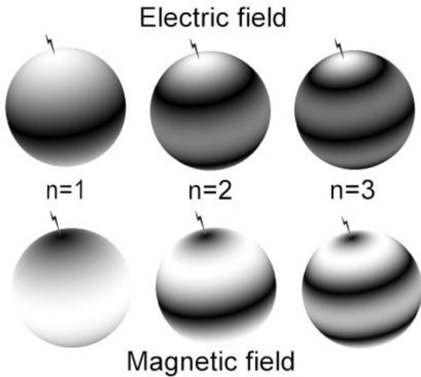
**Рис. 19.** Схематическое изображение нескольких собственных мод резонатора Земля — ионосфера. Сверху показано электрическое поле, снизу — магнитное. Светлые области соответствуют максимумам, тёмные — минимумам. Рисунок из работы Price [2016].
