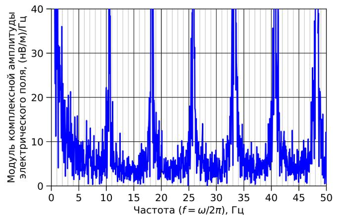
**Рис. 18.** Результаты расчёта модуля комплексной амплитуды радиальной компоненты электрического поля на поверхности Земли в отсутствие проводимости при равномерном распределении источников в полосе от  $30^\circ$  ю. ш. до  $30^\circ$  с. ш. Расчёт проводился для точки наблюдения  $45^\circ$  с. ш.,  $180^\circ$  в. д. и 10000 источников с пиковыми токами в интервале от 0 до 60 кА в течение 30 мин.
