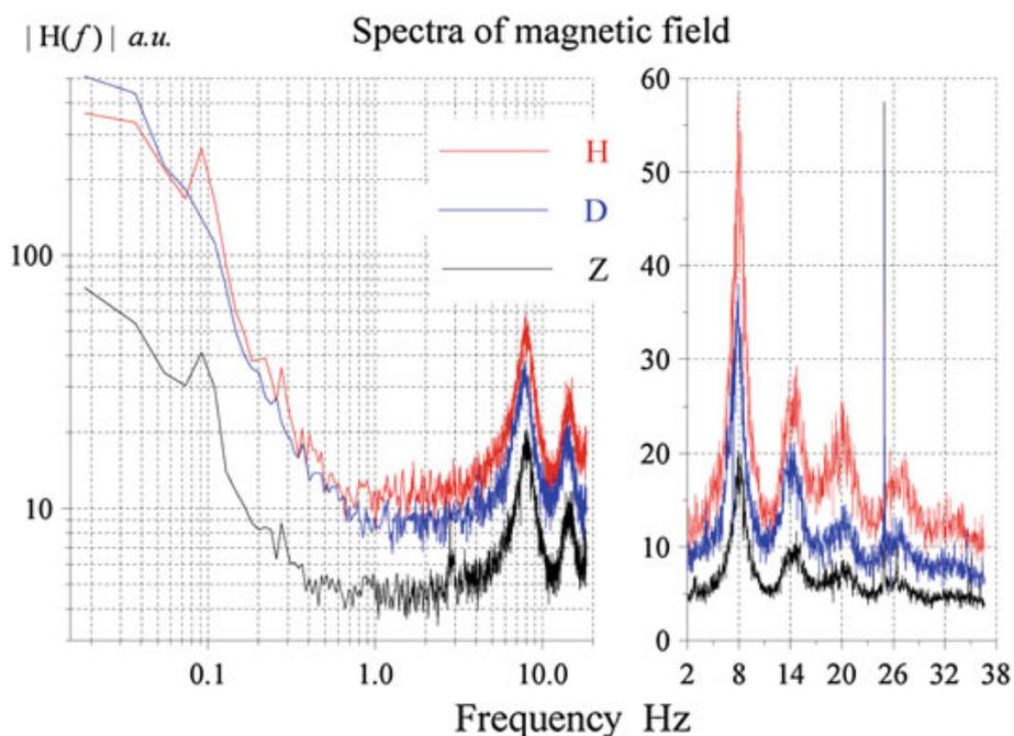
**Рис. 22.** Экспериментально полученные спектры компонент магнитного поля на поверхности Земли (в условных единицах) в диапазоне линейных частот от сотых долей Гц до десятков Гц. Рисунок из книги [Nickolaenko and Hayakawa \[2014\]](#) на основе данных из обсерватории в посёлке Каримшино, Камчатка.
