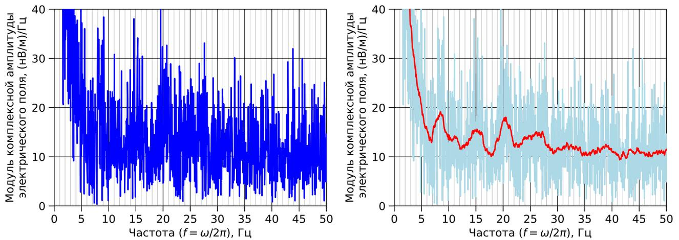
**Рис. 20.** Результаты расчёта модуля комплексной амплитуды радиальной компоненты электрического поля на поверхности Земли в случае профиля проводимости (4) при распределении источников по данным грозопеленгационной сети WWLLN за 18:00–18:30 UTC 1 июля 2020 года. Расчёт проводился для точки наблюдения  $45^\circ$  с. ш.,  $180^\circ$  в. д. Справа дополнительно показано скользящее среднее с симметричным окном усреднения шириной в 4 Гц.
